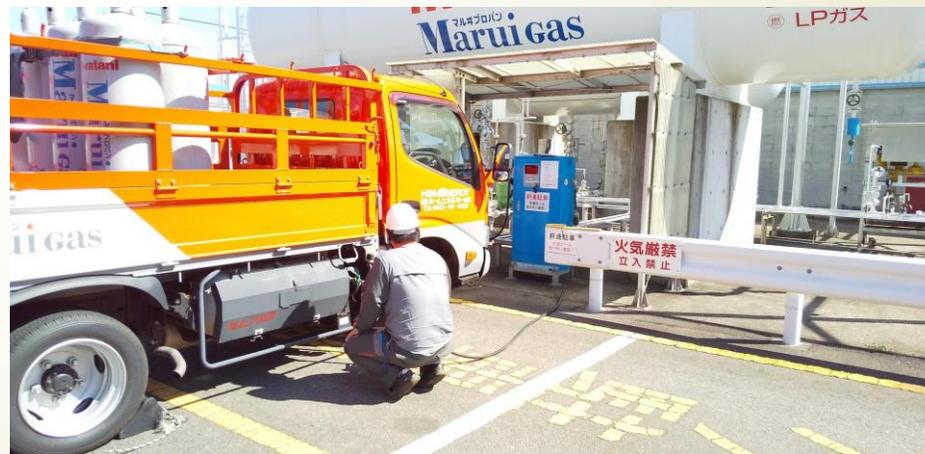
ディスペンサーによるL P ガス車への充填
